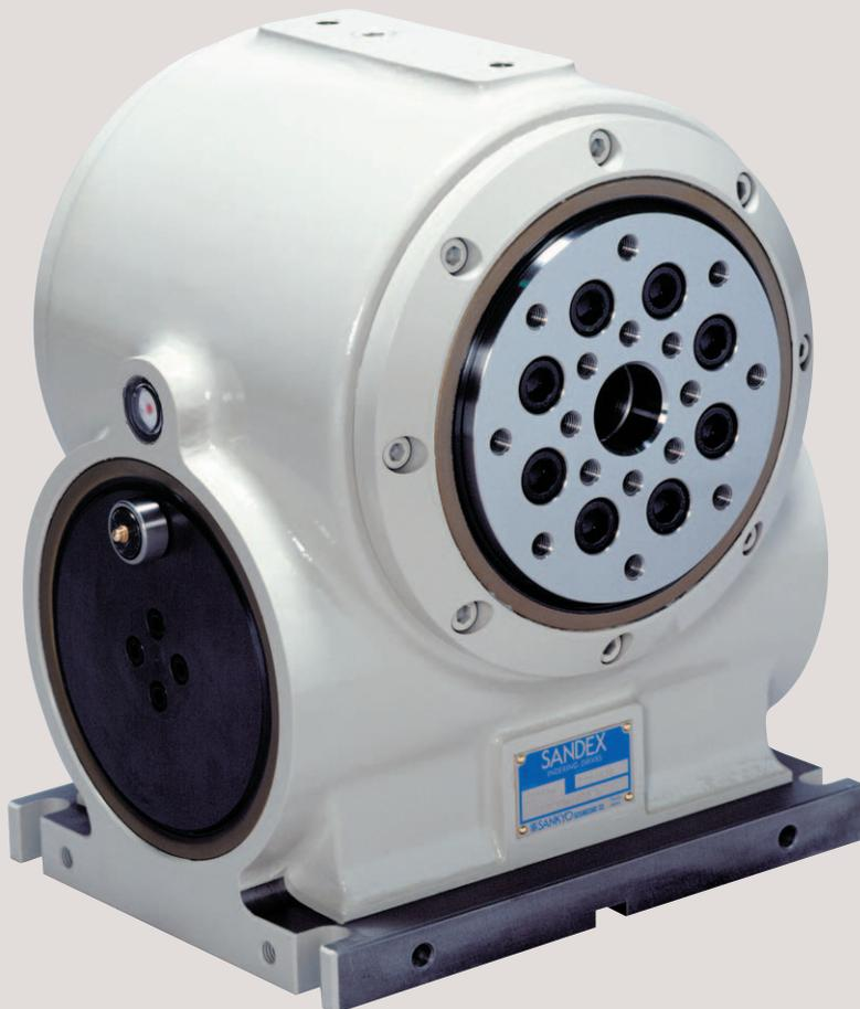
「一度の段取りで完成品まで加工が出来たら」をテーマに開発を進め、三共の最新のカムテクノロジーを加味して完成したのが、このカム式独立回転イケールです。入力軸に取りつけられた大径の回転円盤を回すと、イケール本体に組込まれたローギヤカム機構により、出力フランジが一定の角度だけ割出し回転します。さらにローギヤカムのセルフロック機能により停止中の出力フランジは完全に固定されますので、この動きを利用してワークを所定の位置に回転、停止させ加工を行います。このDSSシリーズは、加工目的に合わせ、割出し角度30°、45°、90°のタイプが揃っています。
